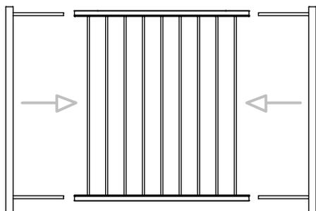
**PASO CINCO:** Haga 16 orificios de 1/8" según el diagrama e instale tornillos Tek de 3/4" para asegurar los extremos de la puerta al panel.
