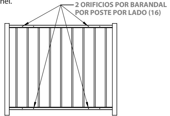
**PASO SEIS:** Mida entre los postes de los extremos de la puerta, reste 1/16" y corte las cubiertas de inserción superior e inferior. Una vez cortadas, coloque las cubiertas de inserción sobre los canales horizontales superior e inferior y presione para colocarlas en su lugar.
