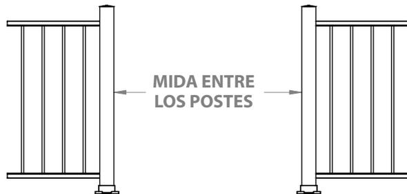
**PASO TRES:** El panel de puerta de estacas (sin los postes de los extremos de la puerta) debe tener exactamente 4.5" menos que la abertura de la puerta. Reste 4.5" de la medida de la abertura y corte ambos extremos del panel, dejando un espacio igual entre estacas.
